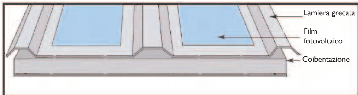
Figura 3. Modulo fotovoltaico non convenzionale consistente in strato metallico, pannello di coibentazione termica e film fotovoltaico
